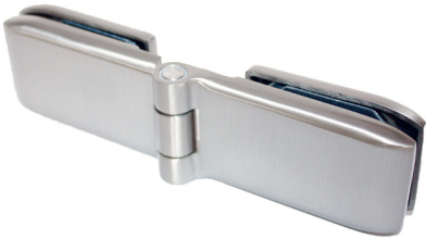
FH400C Felnyíló ajtópánt, csak eloxált alumínium (40kg / 2 pánt)
